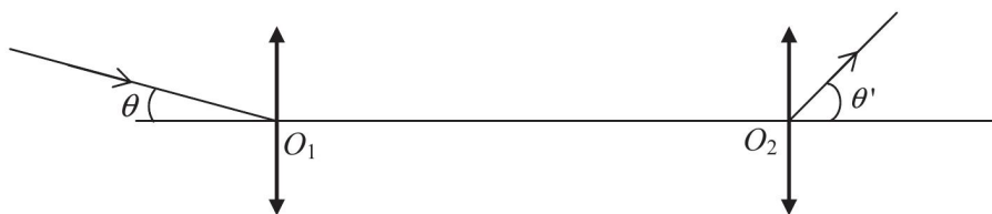
Figure 7 – Schéma d'une lunette astronomique.
